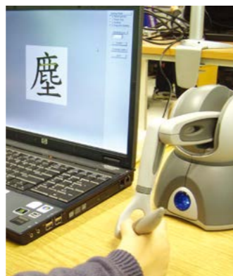
▲ 受訓者可通過觸感仿真裝置的控制器進行手部訓練，圖為進行寫字訓練的觸感仿真平台。
