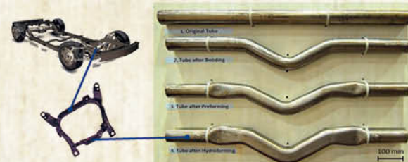
不銹鋼汽車引擎框架上橫樑的形成次序
