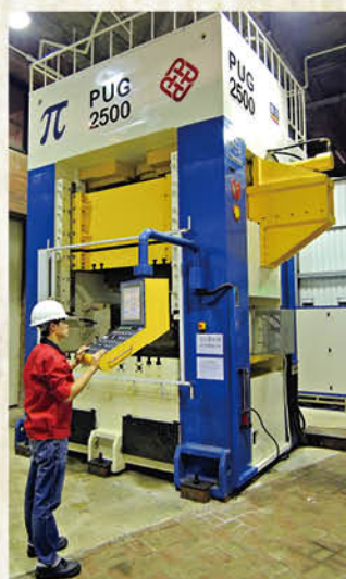
研發成功之大噸位超高內脹壓成形系統
