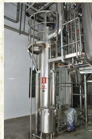
熱泵雙效蒸氣濃縮系統：
