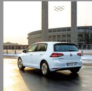
e-Golf 以四門五座揭背設計，標準配置包括「Discover Pro」資訊娛樂系統、可加熱擋風玻璃、自動溫度控制、預設車廂加熱及冷氣功能、皮製軟盤、以空氣動力為設計依歸的「Astana」鋁合金輪圈及 Volkswagen 首次採用的全 LED 頭燈。另一具經濟效益的標準配置是 LED 日間行車燈，其獨特的 C 型設計成為 e-Golf 作為 Volkswagen 純電動車家族成員的獨有標誌。另外，設有一條藍色的裝飾線橫越散熱格柵頂部，與內飾的藍色格調相呼應。
